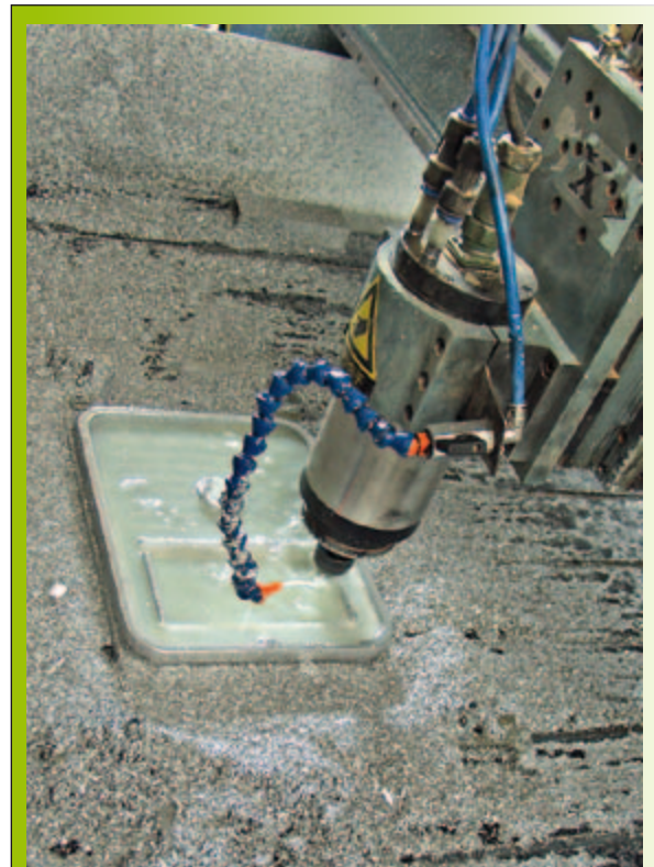
Die ersten Teile in Alu – geschmiert wird mit Bohröl.
