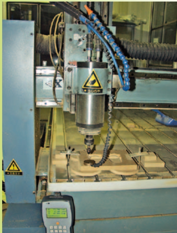
Einstellen des 0-Punktes der z-Achse.
