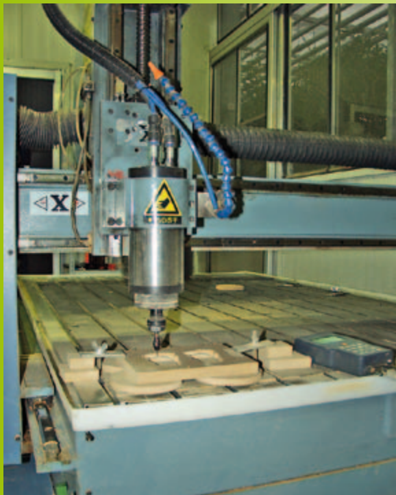
Für das Bohren von 1-mm-Löchern wurde die Spindel mit einem Bohrfutter ausgerüstet.
